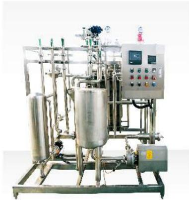
该设备采用超高温处理方法,使液体乳制品、茶饮料、果汁达到严格的灭菌,进而转入无菌包装,其杀菌温度为121-137℃,保温时间为3-5秒,从而尽可能的保持饮料、饮品的原有营养色泽及风味。本设备具有热回收率高,结构紧凑、美观、温度控制等特点;本产品有热灌装,出料温度自控,也可冷灌装。控制方法:半自动、全自动(PLC控制,触摸屏显示)。
