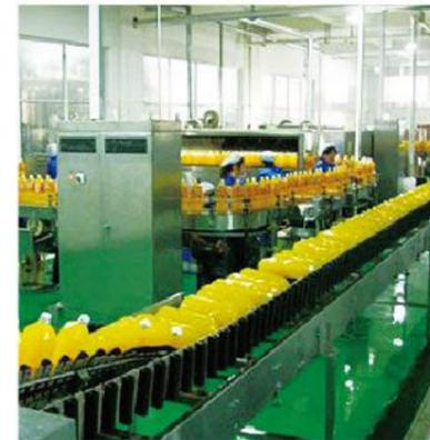
倒瓶杀菌机主要用于PET 聚酯瓶包装的果汁、茶等饮料热灌装后对瓶口、瓶盖内壁未经杀菌或高温处理的部分进行杀菌。本机主要由传送链系统、瓶体反转链系统、机架、瓶子翻转导杆等构成;本机实现自动翻转杀菌和自动复位、而且在杀菌过程中,只须通过瓶子内存物的自身高温对瓶口和瓶盖内壁进行杀菌,不必增加任何热源,达到节能目的。机身采用 304 材料制作,美观大方、使用方便。
