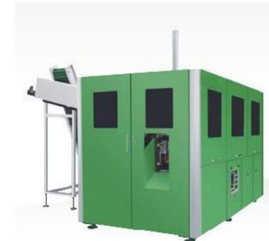
直线式吹瓶机是大通采用当今国际最先进的制瓶技术开发研制的、用高压压缩气体将 PET 瓶胚吹制成型的高速直线式吹瓶机械。此设备自动完成瓶坯排列、加温及瓶子的拉伸吹制，吹瓶技术已达到行业领先水平。
