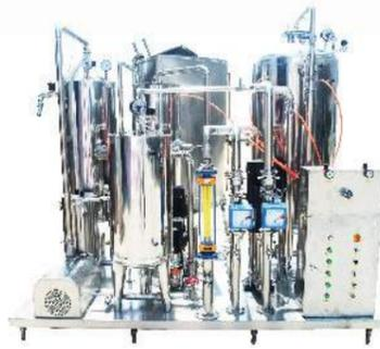
QHS 系列饮料混合机是提高水、糖浆和二氧化碳的比例精确而精心设计制作，采用国外先进技术—静态混合器来减薄水层，增加碳化时间，确保饮料混合效果；采用二氧化碳回流脱氧，既节省二氧化碳，又达到脱氧的目的；优质的水泵和西门子电器等组成完善的自动控制系统，具有动作协调、外形美观、清洗便利、自动化程度高等优点，适用于多种类型饮料的混合。如汽水、可乐、苏打水等饮料。
